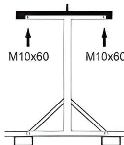
Des trous sont placés aux extrémités de chaque barre ainsi que sur les platines du rack. Fixez les éléments avec les boulons que vous trouverez dans la visserie du rack de stockage.
